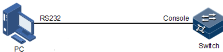
图1-1 通过 PC 连接 RJ45 Console 口登录设备的组网示意图
