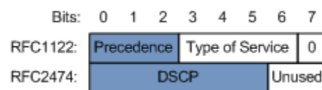
图8-3 IP 优先级和 DSCP 优先级报文结构示意图
