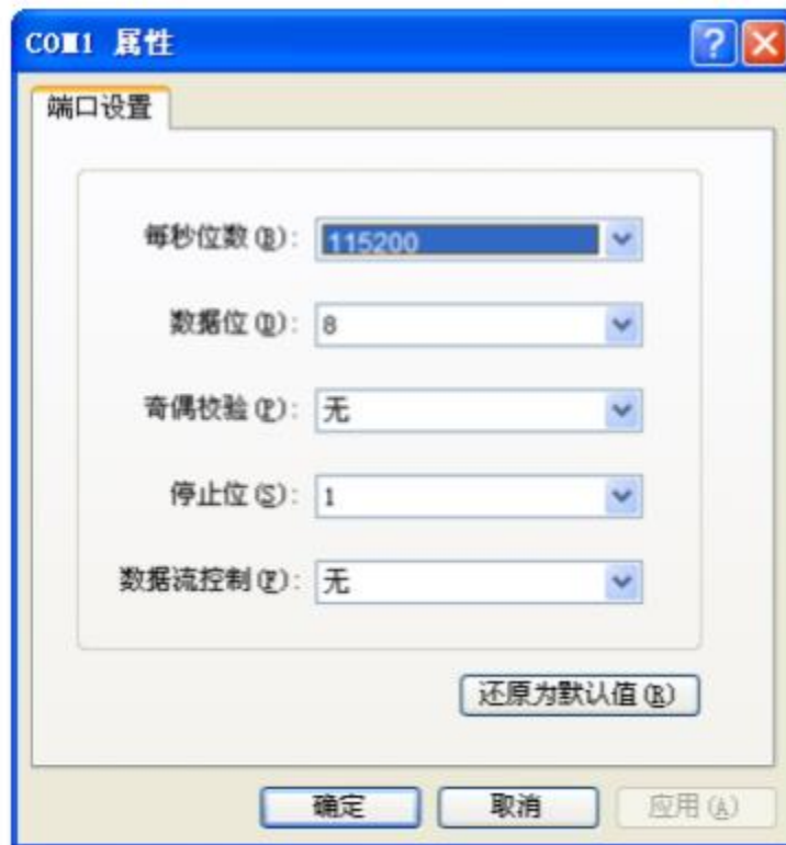
图1-2 “超级终端”中的通信参数配置示意图
